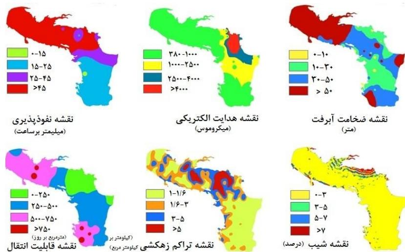
شکل (۳) نقشه‌ی عوامل مؤثر بر مکان‌یابی تغذیه‌ی مصنوعی به روش پخش سیلاپ
