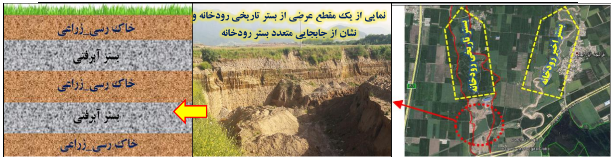
شکل (۵): نمایی از پروفیل طولی و عمقی بستر اخیر و تاریخی رودخانه، نمونه برای قلمرو بازه R.8.3
