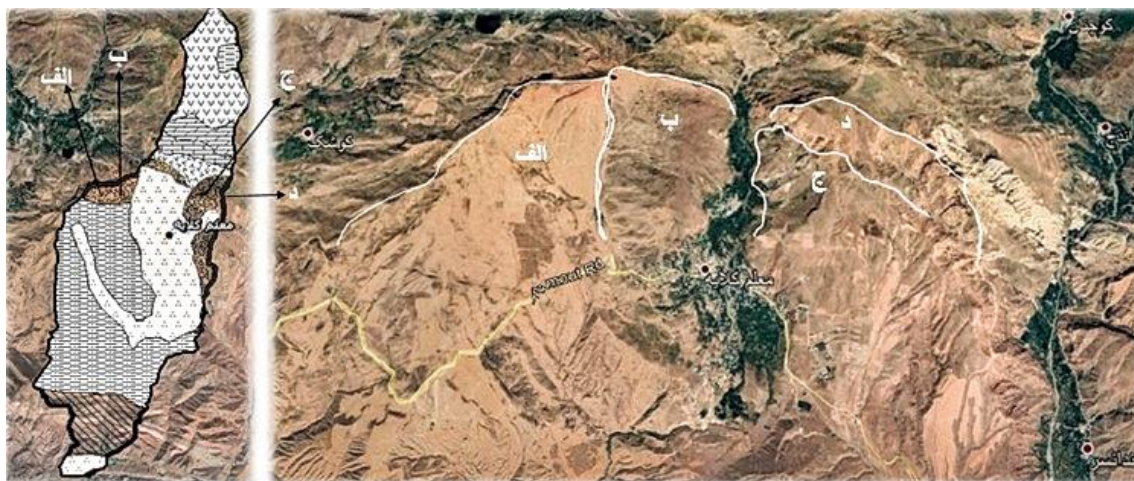
شکل (۷): زمین‌لغزش در لیتولوژی مجاور کنگلومرا. الف) سیلتستون. ب) کنگلومرا. ج) سیلتستون. د) کنگلومرای مسلط به سیلتستون.
